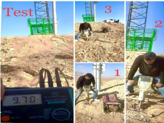
شکل (۱۰): مقاومت الکتریکی زمین واقعی در روش اجرایی الکترودهای میله ای ۳ متری پیپای با فاصله ۶ متر
