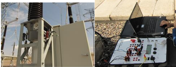
شکل (۹) - دستگاه Switch - Analyser و سنسور متصل به شفت
