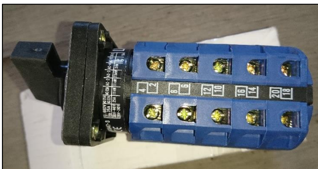
شکل (۵): کلید L/R جایگزین شده در تابلوی پُل فاز C بریکر ۴۰۰ کیلوولت
