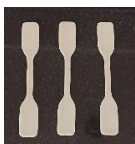
شکل (۲) : نمونه های دمبلی جهت تست
