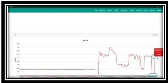
شکل (۲): رویت پذیری قطع و وصل شدن بار فیدر در سامانه مدام
